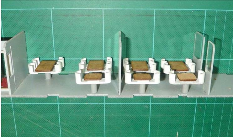
Nachdem die Sessel werden die weitere Bistro Polster auf die Bodenplatte montiert wie die Rundtische, Theke, Schrank etc.
