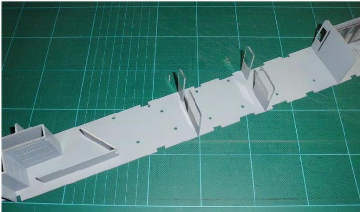
Der Abteilwand in Plexi wird mit die andere Abteilwände in MDF auf die Bodenplatte montiert.
