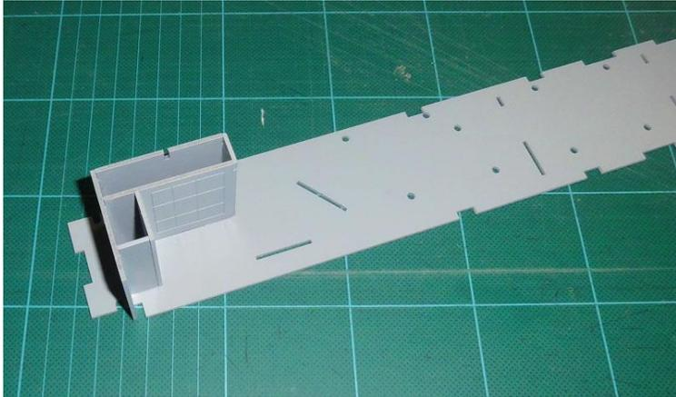
Die Abteilwände in Plexi werden in die Boden Schlitten montiert, wie das Bar Tragrahmen..
